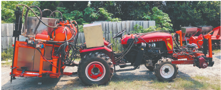
切根气爆松土注射施肥复式作业机
